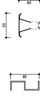
S-캐링찬널 클립바 DETAIL SCALE : 1/12
